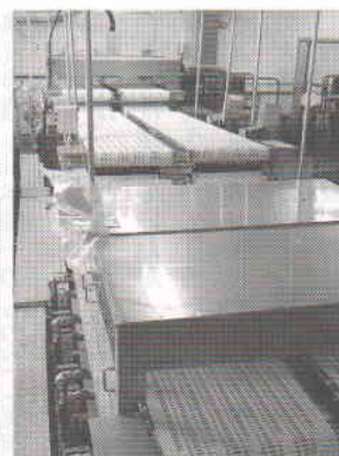
自社で製作した野菜洗浄機。→
